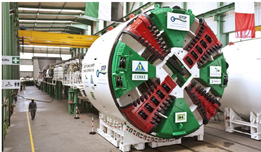
9 TBM Herrenknecht Projekt STEP Abu Dhabi.
